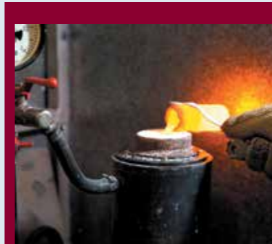
4. Заливка расплава в форму
