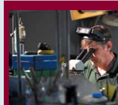
8. Некоторые детали знака требуют применения дополнительных оптических приборов, например биноккулярного микроскопа
