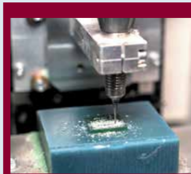
1. Вырезание модели из полимера на станке с ЧПУ
